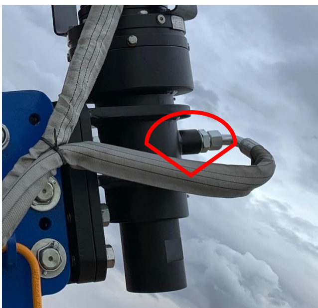
Fig 3 Conexiune de aer
